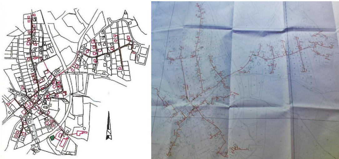
Abb. 14 & Abb. 15: Ortsnetzwerkplan Biomasse von 1996 im Vergleich zu den aktuellen 125 Anschlüssen von 2016 (Quelle: FERNWÄRME ZELL AM MOOS, REG. GEN. MBH 1996 & PÖCKL, J. 2016).
